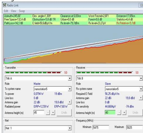
Gambar 8. Perhitungan simulasi *Radio Mobile* pada frekuensi 5,8 GHz dengan *data rate* 54 Mbps
