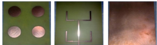
Gambar 7. Antena mikrostrip patch circular yang telah difabrikasi.
