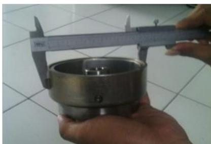
Gambar 2. Pengukuran Diameter Magnet
