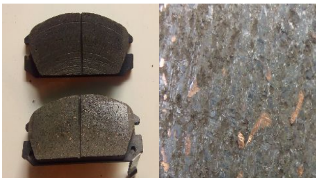
Gambar .7 Foto & Foto Makro Kampas Rem Nissin
