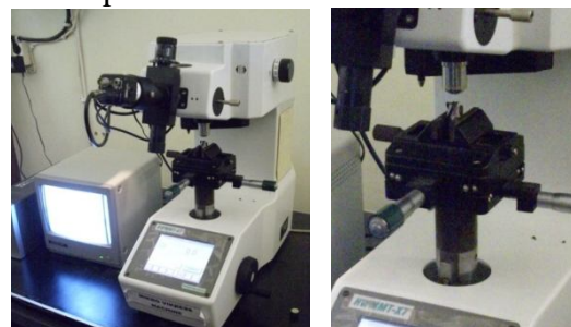
Gambar 24. Pengukuran Keausan Tepi Cutter End Mill
