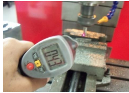
Gambar 17. Pengukuran Suhu Cutter dengan Infrared Thermometer
