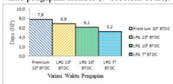
Gambar 11. Histogram Hubungan Daya pada Poros Roda dengan Bahan Bakar Premium pada Waktu Pengapian 10^0 BTDC dan Bahan Bakar LPG pada Variasi Waktu Pengapian 13^0 BTDC, 10^0 BTDC dan 7^0 BTDC
