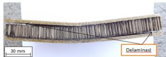
Gambar 4. *Delaminasi* Akibat Beban *Bending* pada Komposit *Sandwich*
