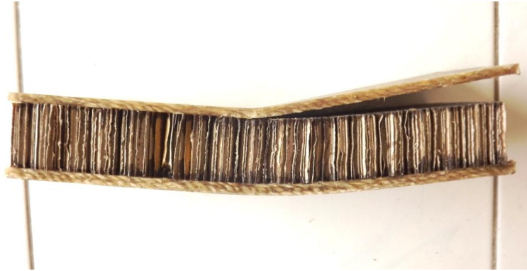
Gambar 8. Delaminasi Spesimen Uji
