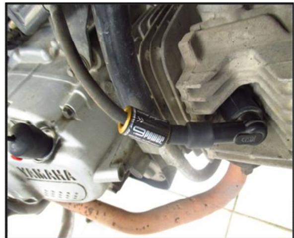
Gambar 3. Pemasangan Ignition Booster Pada Kabel Busi
