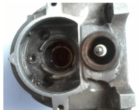
Gambar 1. *Cylinder Head* Yamaha Jupiter Z dengan 2 buah busi
