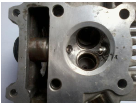
Gambar 3. Pandangan Atas Cylinder Head Yamaha Jupiter Z Dengan Busi Ganda
