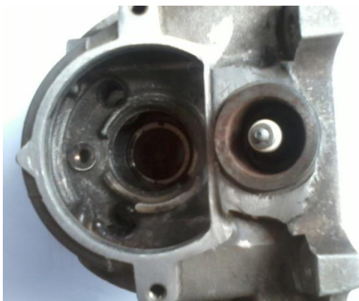
Gambar 4. Pandangan Samping Cylinder Head Yamaha Jupiter Z Dengan Busi Ganda
