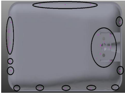
Gambar 7. Hasil Analisis Simulasi Air Traps Produk Injection Molding dengan Melt Temperature 200°C
