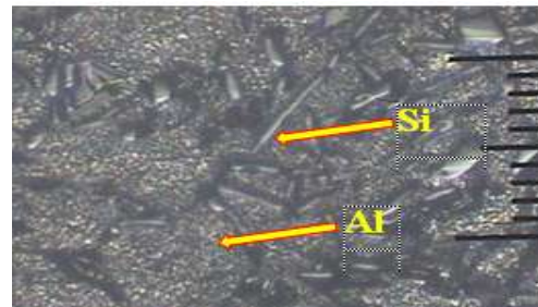
Gambar 5. Foto Struktur Mikro Daerah Las Perbesaran 200x
