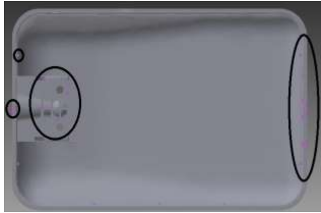
Gambar 3. Hasil Simulasi Air Traps dengan Injection Time
