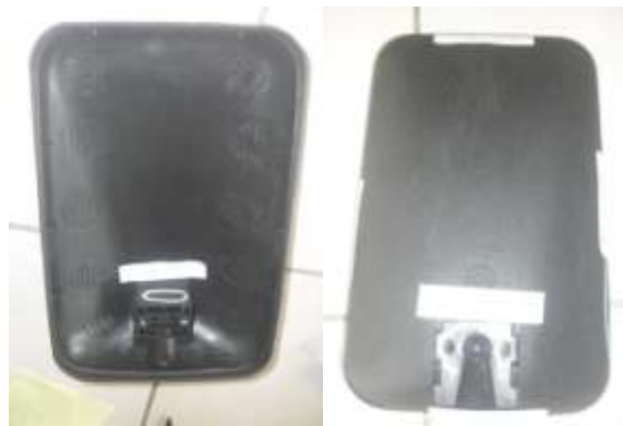
Gambar 12. Hasil Injeksi dengan Parameter Injection Time 6,5s
