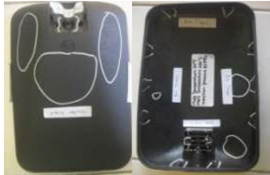
Gambar 11. Hasil Injeksi dengan Parameter Injection Time 2s
