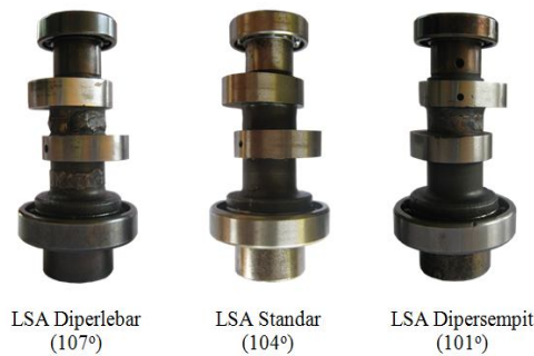
Gambar 6. Hasil Akhir Modifikasi LSA Camshaft
