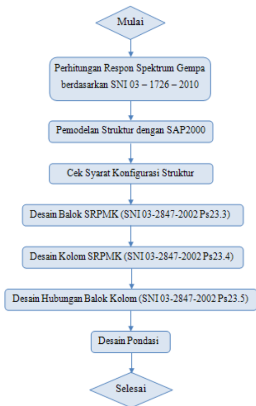
Gambar 1. Flowchart Perencanaan Struktur dengan Metode SRPMK
