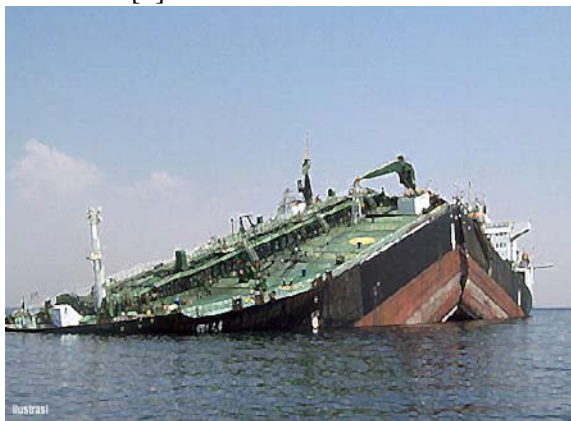
Gambar 8 Kapal patah akibat fatigue
