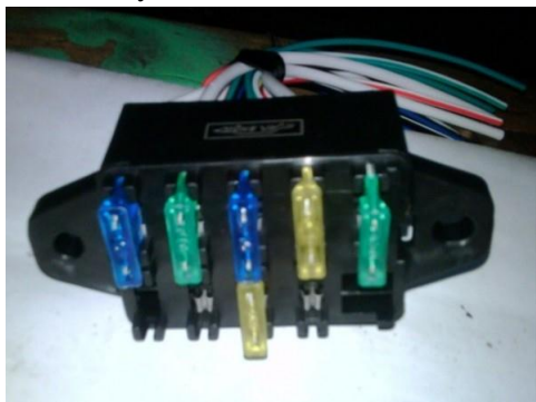
Gambar 12. Fuse box sekering
