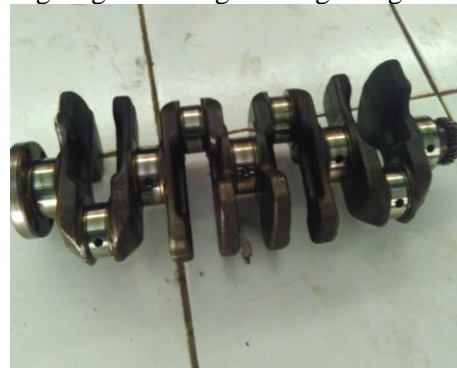
Gambar 16 : Kondisi saluran oli dari poros engkol
