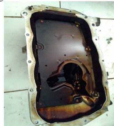
Gambar 23 : Penggantian perpak bak oli
