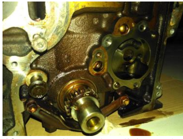
Gambar 18 : Pemeriksaan kondisi rumah pompa oli
