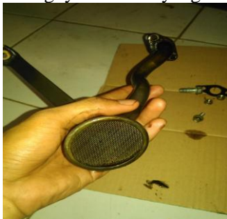
Gambar 20 : Kondisi saringan bawah
