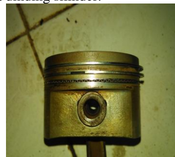
Gambar 17 : Kondisi ring oli pada piston
