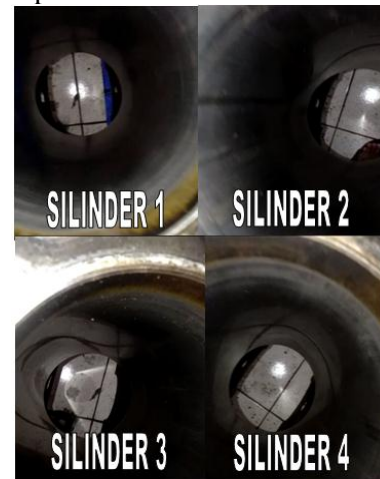
Gambar 1. Pemeriksaan Silinder Secara Visual
