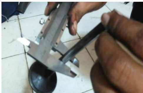
Gambar 15: Pemeriksaan Diameter Batang Katup
