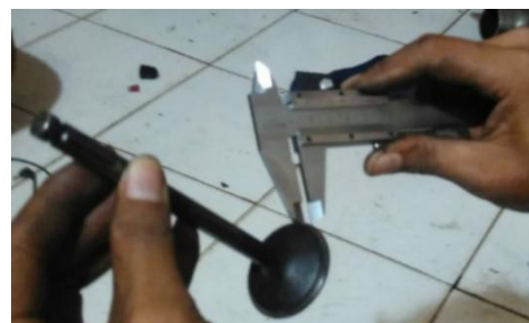
Gambar 18: Pemeriksaan Lebar Dudukan Katup
