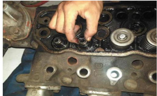
Gambar 21: Pemeriksaan Seal Katup
