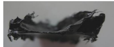
Gambar 6. Foto makro rongga pada komposit metode cetak tebal
