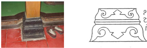
Gambar 17. Kaligrafi. Kiri: pada umpak ruang Pendopo dan ruang Jawa tengah. Kanan: Sketsa kaligrasi pada umpak (: Arsitektur tradisional DIY)
