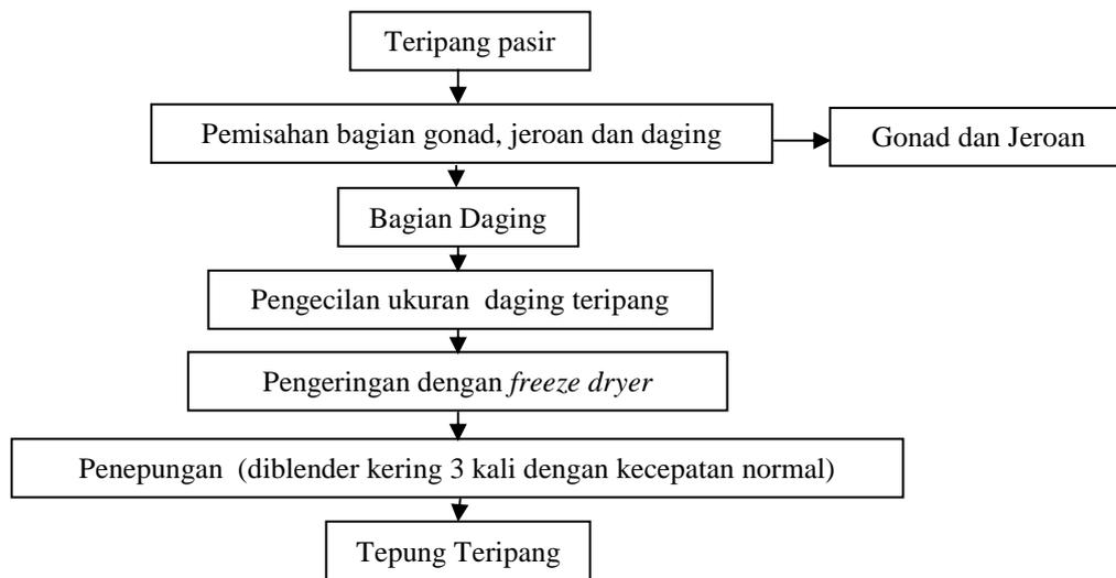
**Gambar 2. Diagram alir proses pembuatan tepung daging teripang**
