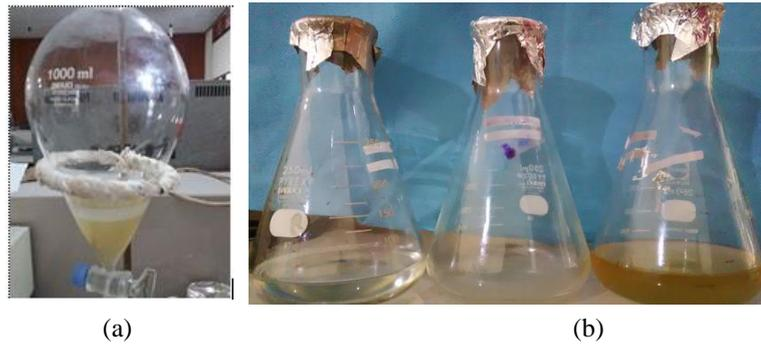
Gambar 1. (a) Hasil ekstraksi menggunakan etil asetat (b) pemisahan hasil ekstraksi yang membentuk 3 lapisan yaitu etil asetat, lemak dan air (dari kiri ke kanan).
