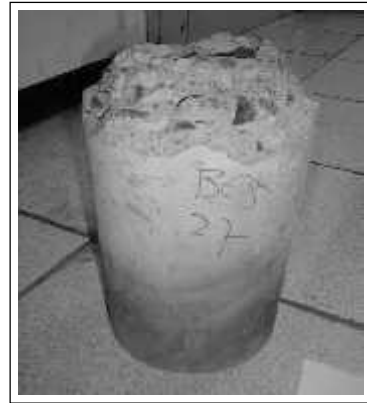
Gambar 8. Rompal Pada Beton
