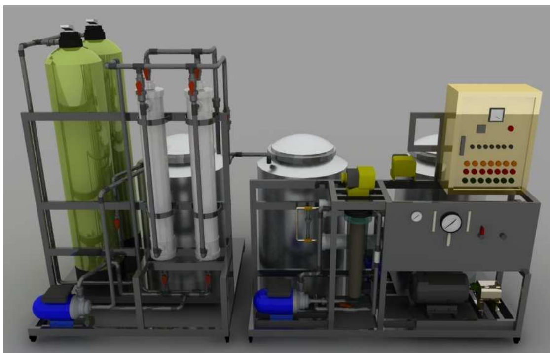
Gambar 4. Unit skala pilot integrasi UF-RO untuk pengendalian fouling pada proses desalinasi
