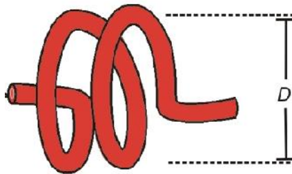
Gambar 2. Skematik sensor MI bentuk kumparan
