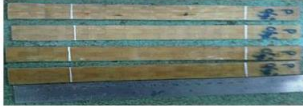
Gambar 4 Spesimen anyaman tipe plain weave dengan sudut orientasi 0° / 90°
