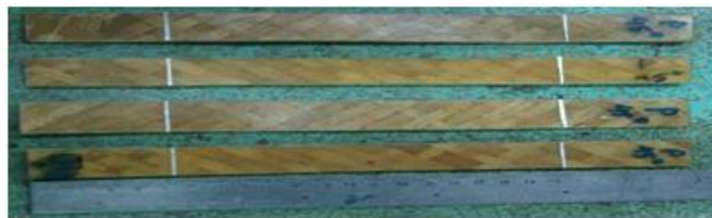
Gambar 5 Spesimen anyaman tipe plain weave dengan sudut orientasi 45°
