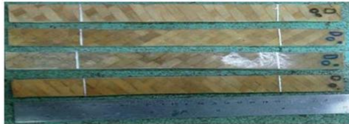
Gambar 7 Spesimen anyaman diamond braid dengan sudut orientasi 0°
