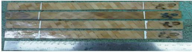
Gambar 9 Spesimen anyaman diamond braid dengan sudut orientasi 90°
