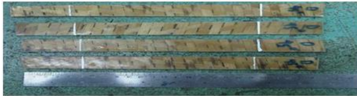
Gambar 8 Spesimen anyaman diamond braid dengan sudut orientasi 45°
