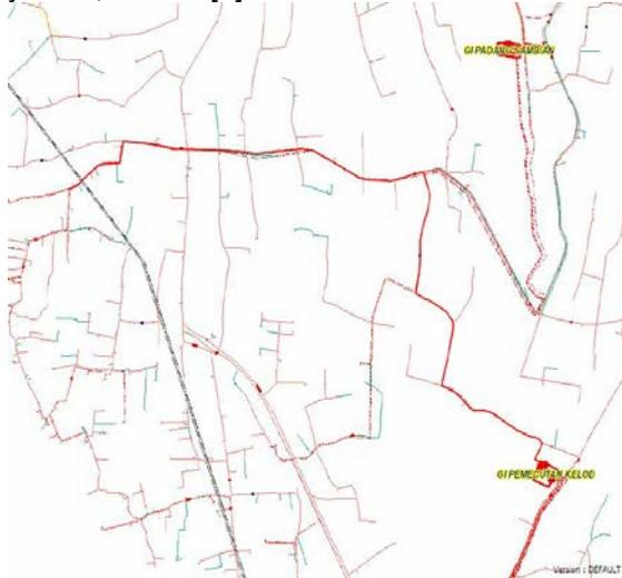
Gambar 7. Jalur kabel tanam dari GI Pemecutan Kelod ke Batu Belig 2
