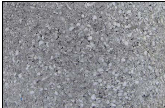
Gambar 5. Tekstur permukaan bata styrofoam
