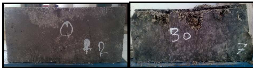
Gambar 3. Batako Semen Portland Normal dan Batako Semen Portland Dengan Bahan Tambah Kertas Koran yang Hancur Setelah Mencapai Gaya Tekan Maksimum
