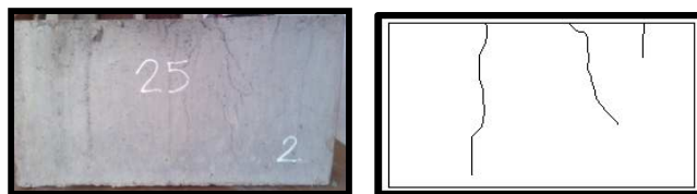
Gambar 10. Pola Keruntuhan Tekan Batako Semen Portland Dengan Konsentrasi Kertas Koran 25% Volume Pasir
