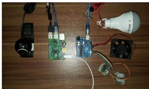
Gambar 2. Perangkat keras sistem (dari kiri: *webcam* USB dengan mikrofon *built-in*, Raspberry Pi, Arduino, lampu LED, kipas DC, *driver* dan motor *stepper*)
