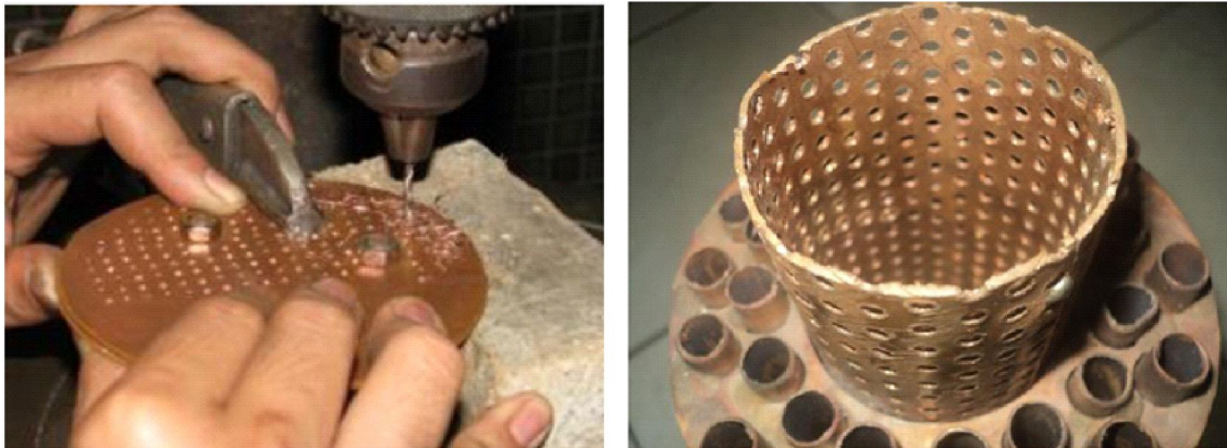
Gambar 5. Proses Pemotongan dan pemasangan pipa katalis
