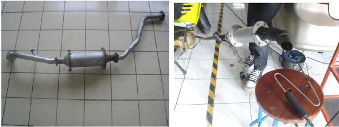
Gambar 7. Pengambilan data pada catalytic converter yang telah dirakit
