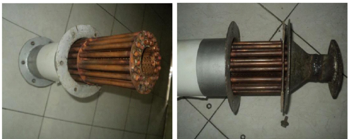
Gambar 6. Bagian dari catalytic converter yang telah dirakit
