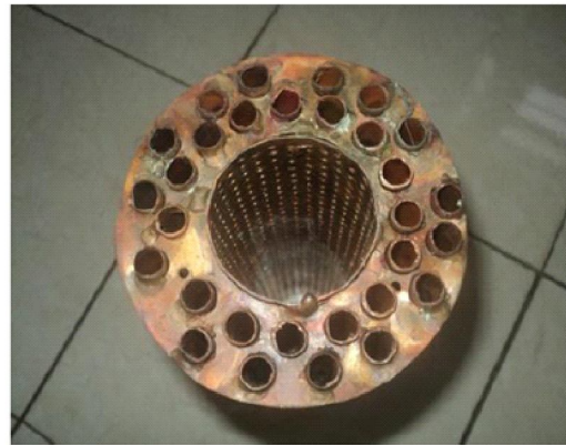
Gambar 1. Susunan pipa katalis
