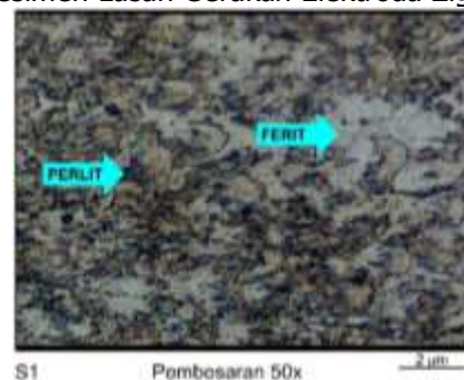
Gambar 22 Foto Struktur Mikro Daerah HAZ Spesimen Lasan Gerakan Elektroda Spiral
