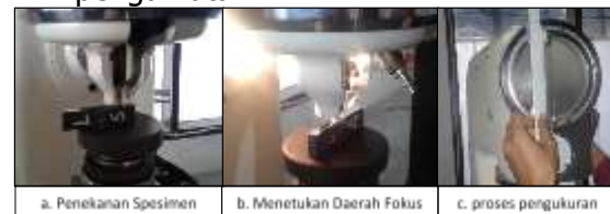
Gambar 10 Pengujian Kekerasan Vickers Pengamatan Struktur Mikro
