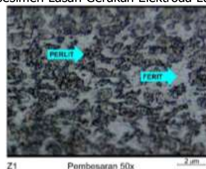
Gambar 21 Foto Struktur Mikro Daerah HAZ Spesimen Lasan Gerakan Elektroda Zig-zag
