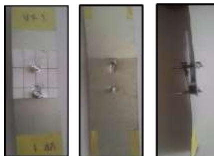
**Gambar 5.** Kegagalan Pada Konfigurasi II (Vertikal)
