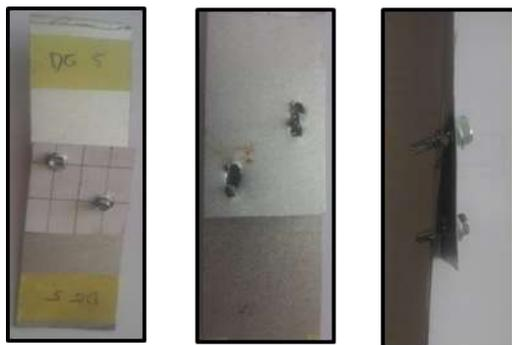
**Gambar 4.** Kegagalan Pada Konfigurasi I (Diagonal)
