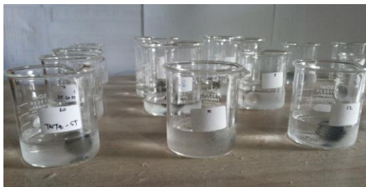
Gambar 2. Spesimen dimasukkan ke dalam larutan saliva buatan (pH asam)
