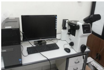
Gambar 4. Mikroskop optik untuk pengamatan struktur mikro, M hingga 100x
