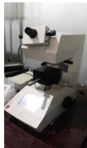
Gambar 3. Alat uji kekerasan merk HMV Shimadzu, Japan
