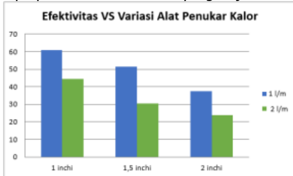
Gambar 6. Grafik perbandingan efektifitas terhadap variasi diameter selongsong alat penukar kalor pipa ganda
