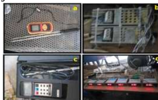
Gambar 2. Instrumen yang digunakan: a. Moisture meter , b. Speed Controller , c. Digital thermocouple , d. Digital Anemometer Sebelum mesin pengering rak telur dioperasikan, seluruh bagian sistem dan peralatan pengukuran dipastikan dalam kondisi baik. Mesin Pengering Rak Telur dioperasikan selama 150 menit dengan pengambilan data yang dilakukan tiap 5 menit. Pengukuran dan pengambilan data dilakukan selama 150 menit, meliputi:
