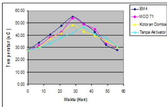
Gambar 1. Grafik hubungan temperatur kompos selama proses pengomposan
