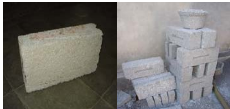
Gambar 9. Batako dari styrofoam dan bata dari styrofoam produk Ds. Sukunan
