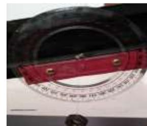
Gambar 9. Busur derajat dipasang pada bagian mekanik untuk penentuan sudut kemiringan
