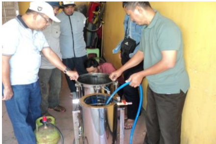
Gambar 8. Pengisian ketel dan kondesor dengan air
