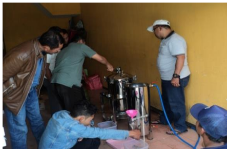
Gambar 9. Pemisahan minyak atsiri jahe dan air suling dengan corong pemisah
