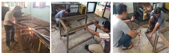
Gambar 4. Pembuatan mesin pemotong dan perata batu portabel sistim ulir
