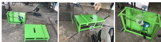
Gambar 5. Hasil temuan teknologi mesin pemotong dan perata batu portabel sistim ulir (Ready)
