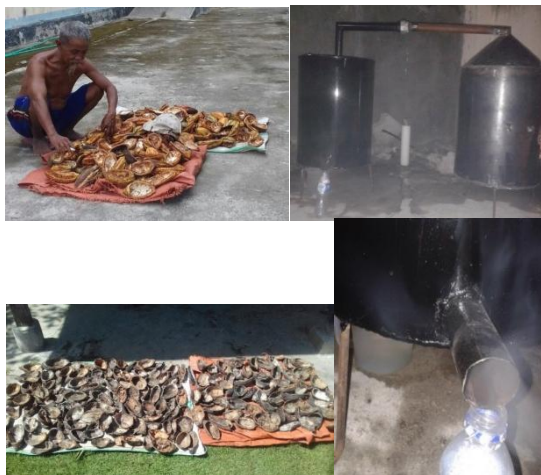
Gambar 5 Proses pembuatan asap cair
