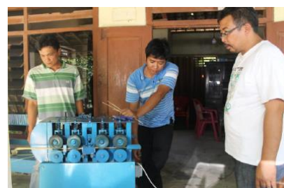
Gambar 6. Mesin ruji bambu dan pelatihannya
