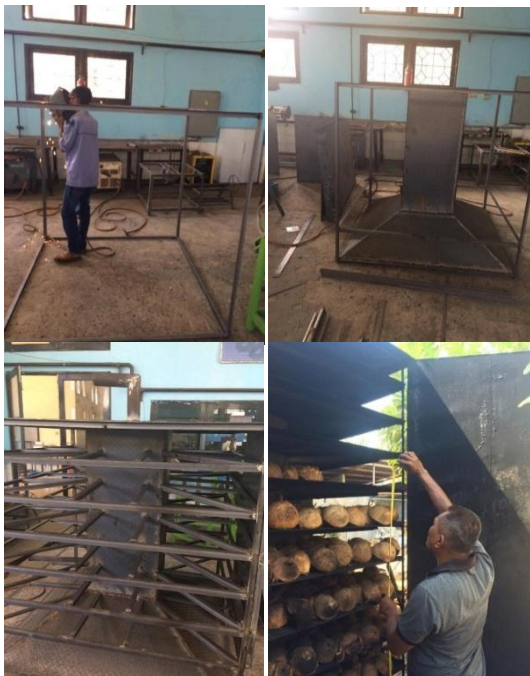
Gambar 1. Proses Pembuatan Oven Pengering Kopra Multi-Fungsi Sistem Tungku Vertikal
