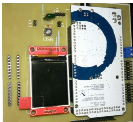
Gambar 10. Rangkaian Monitoring Tegangan
