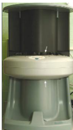
Gambar 6 Scanner laser Scan X. Plate storage phosphor dimasukkan ke bagian atas scanner (panah atas) dan dikeluarkan (panah bawah) setelah proses scan selesai.
