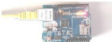
Gambar 4.1 Pengujian Rangkaian Arduino dengan Ethernet Shield W5100
